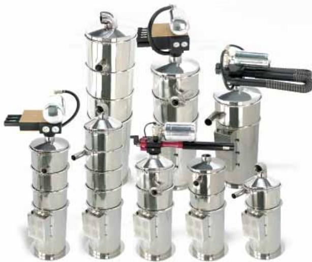
Las tolvas de aspiración AR constituyen la mejor solución para el transporte por vacío a distancias de hasta 20 m. Las tolvas se montan sobre el punto donde se desea descargar el material, por lo que son ampliamente utilizadas para alimentar máquinas inyectoras, extrusoras o máquinas de envasado automático.
