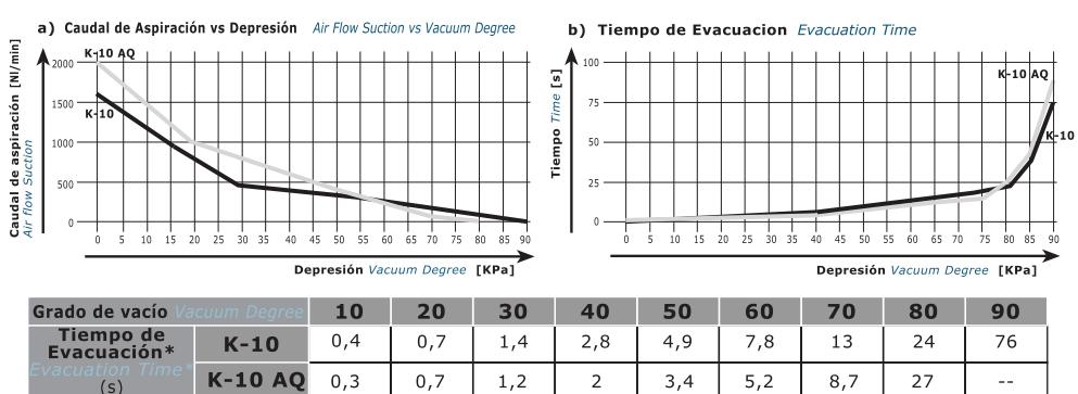
\*El ensayo se ha realizado en un depósito de 100 L de volumen The trial was made in a 100 L deposit volume.
